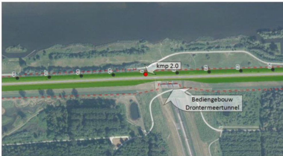
Figuur 13: Bovenaanzicht dijkontwerp bij circa km 2.0 spoortunnel en Bediengebouw Drontermeertunnel
