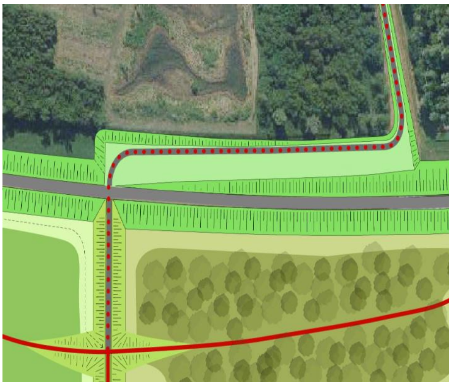
Figuur 15: Bovenaanzicht principe-inpassing aansluiting Stobbenweg en Reevedam (gestippelde lijn)
